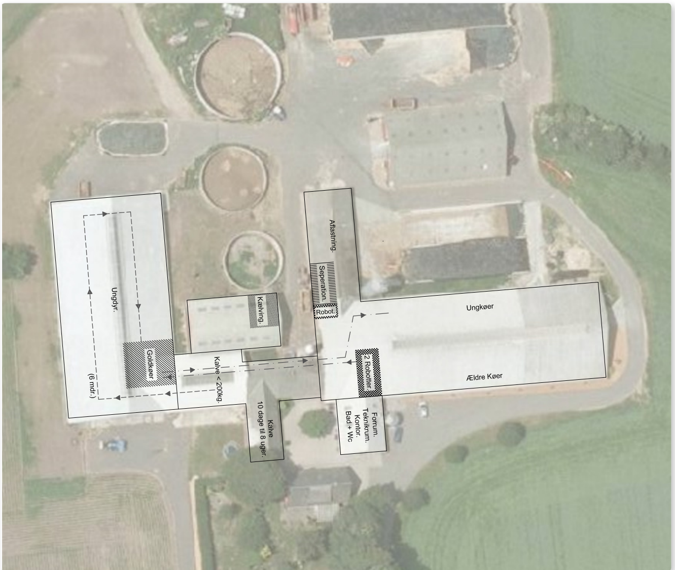
Figur 8. Diagram over drivgange. Diagrammet er benyttet i planlægningsfasen, hvor man ønskede logistisk at arbejde med transporten med det mål at opnå større effektivitet. På diagrammet er udelukkende indtegnet fodertransporten (pilene illustrerer fodertransporten), men kunne nemt suppleres med de andre eksisterende transportere og dermed illustrere områder, hvor der er risiko for ulykker.
